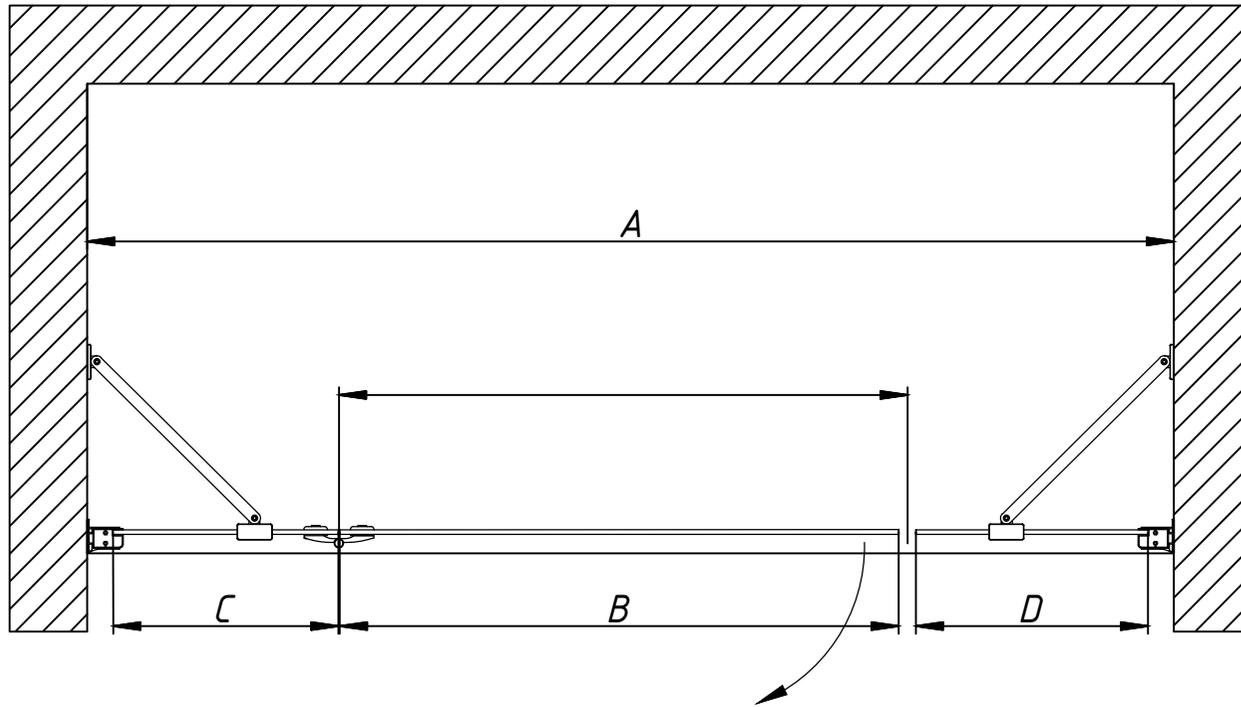
Регулировка осуществляется путем выдвигания профиля. Размеры указаны в мм.
