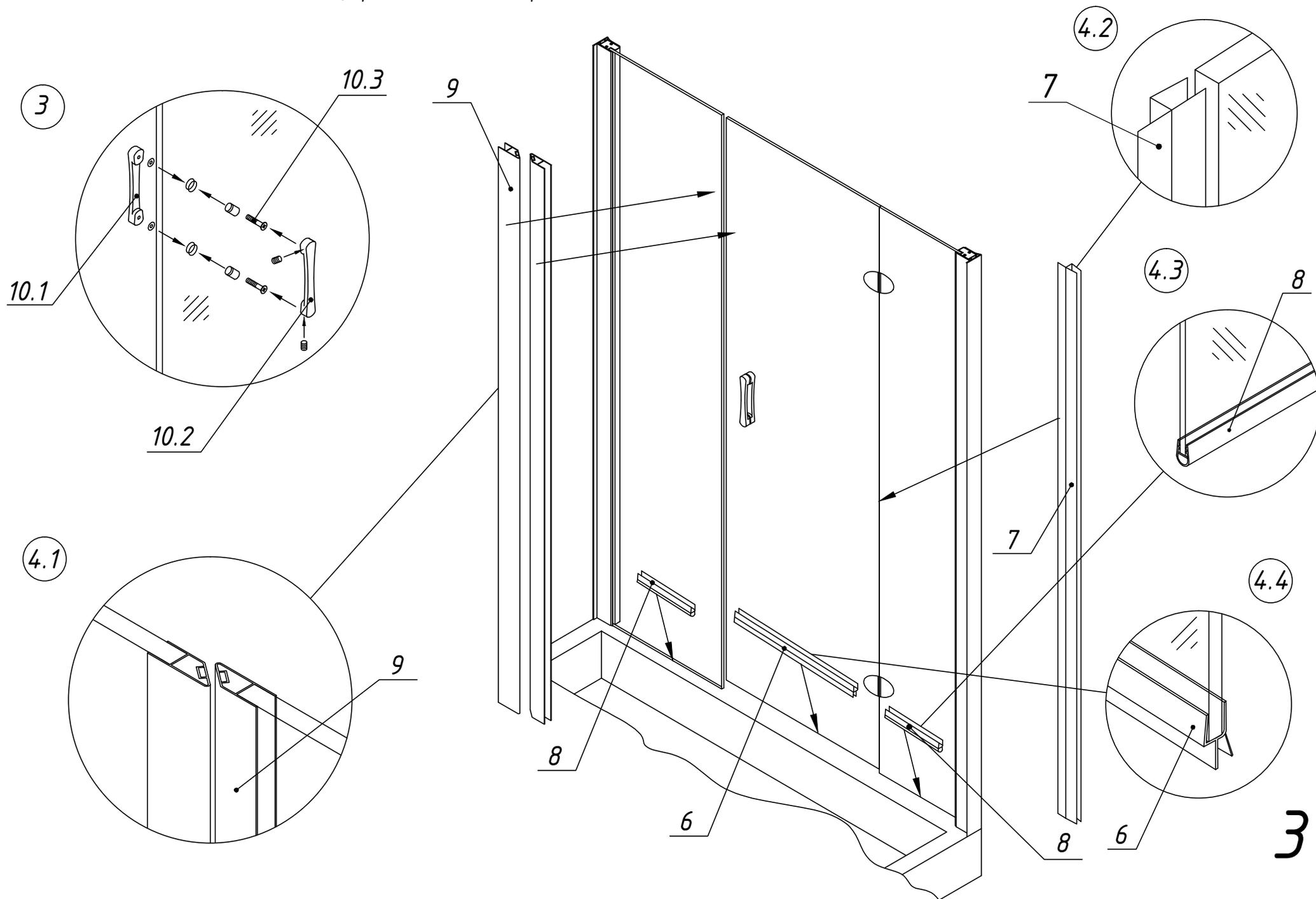
5. Произвести сборку и монтаж фиксаторов для стекла.
