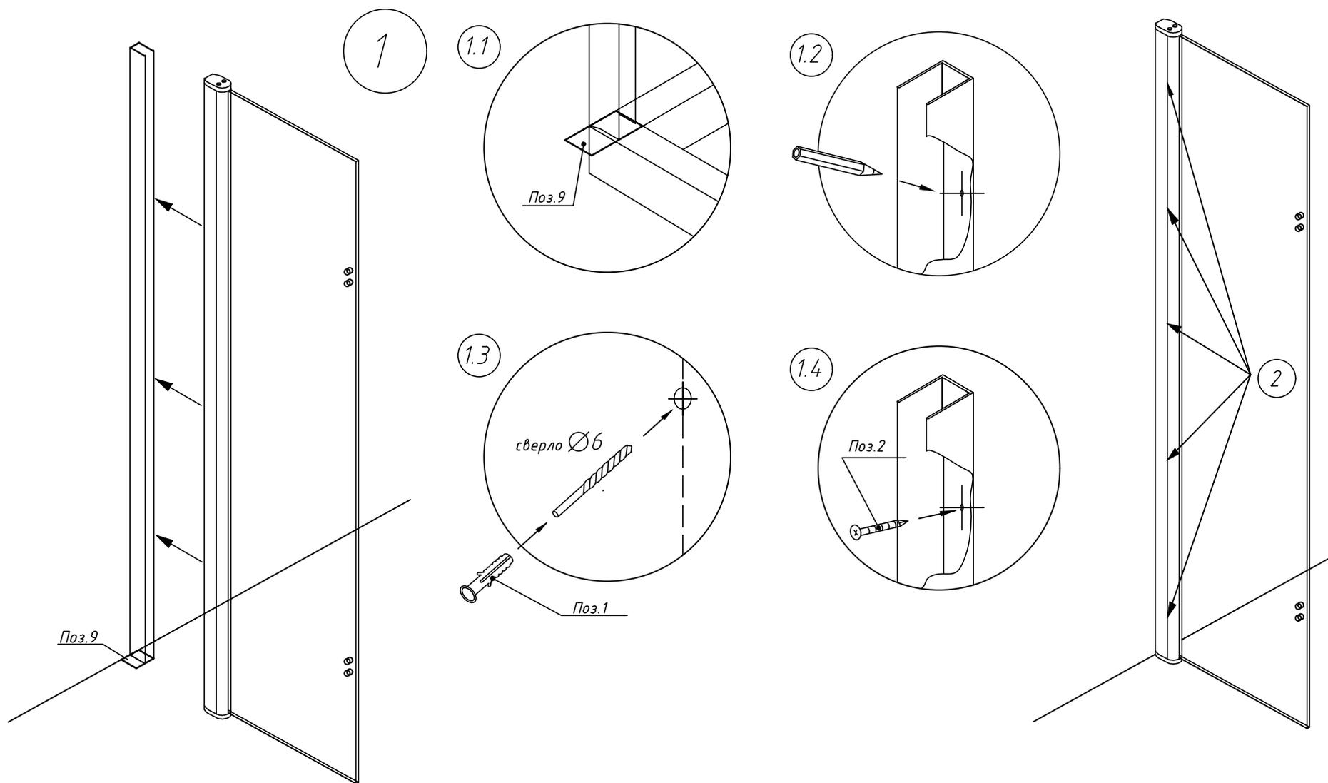
3. Произвести монтаж силиконовых уплотнителей на дверь и стационары.
