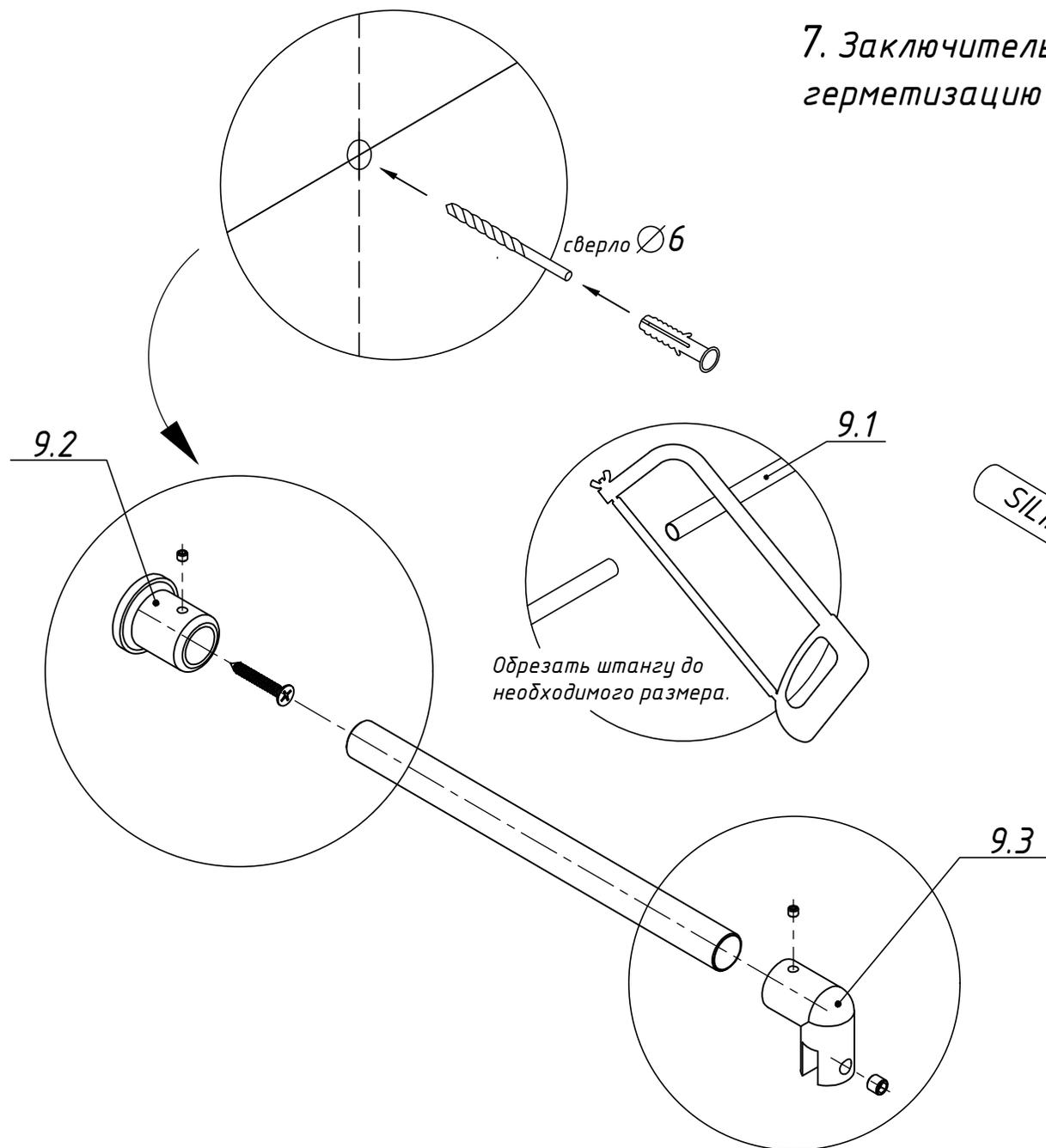
7. Заключительный этап монтажа: произвести герметизацию соединений (с внутренней стороны).
