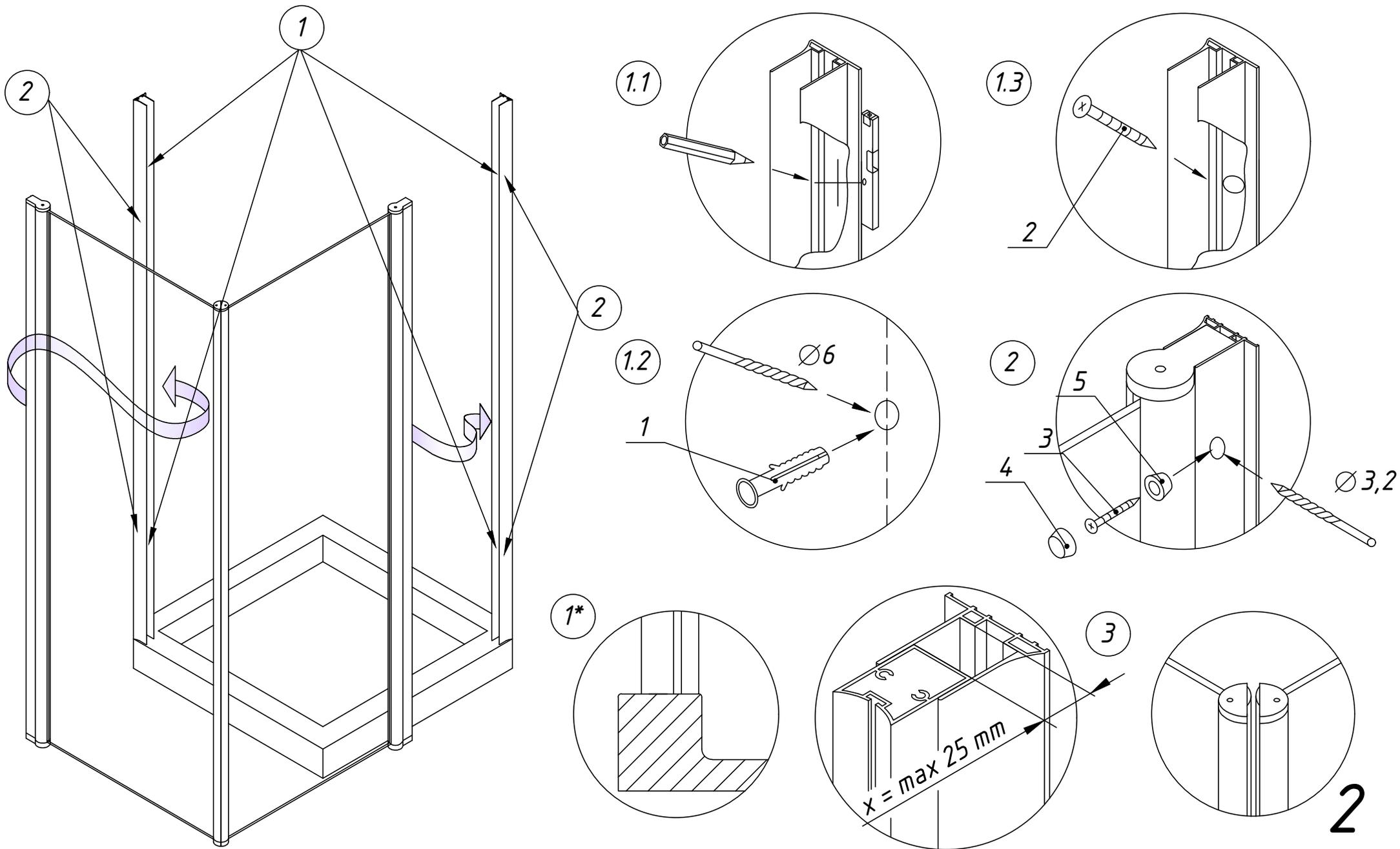
**4.** Произвести монтаж силиконовых уплотнителей на дверь и стационар.
