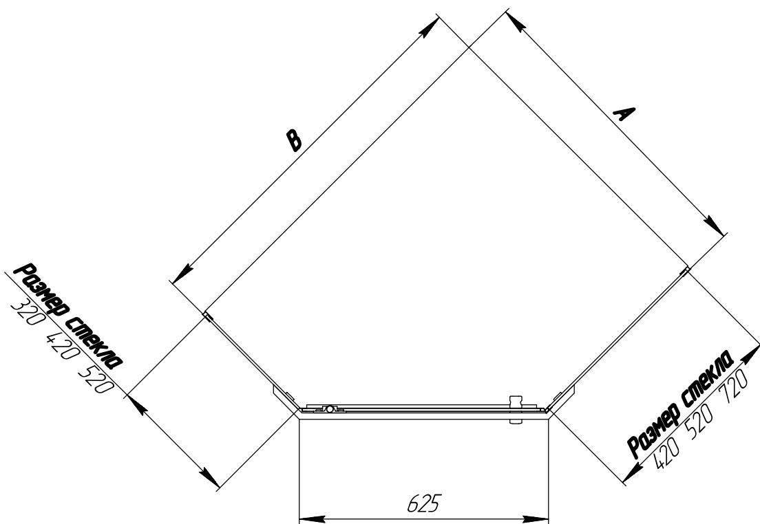
Регулировочный размер А - от угла до наружней кромки профиля изделия.
