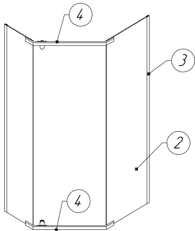
6. Разберите петли на трапециях (4) и установите стекло двери (1). Установите на стекло ручку (5). Установите магнитный уплотнитель (6) на дверцу (1) и стационарное стекло (2). Установите уплотнитель (9) на стационарное стекло. Установите уплотнитель (7) на дверцу. На низ двери установите уплотнитель (8).
